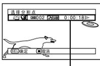
通过按DISPLAY（显示）按钮可以关闭或打开正在播放的场景的状态条形图
