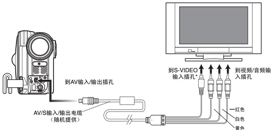
\* 如果您的电视机有S-VIDEO (S-视频) 输入插孔，就可以用S-VIDEO (S-视频) 电缆连接了。
