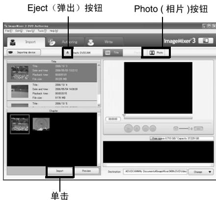
单击“Photo（相片）”按钮将显示录制在DVD-RAM上的相片。选择所需相片（一张或多张），然后单击“Import（导入）”：相片（一张或多张）将被导入个人计算机。如果要在导入某个光盘上的影像后导入其他光盘的影像，请单击“Eject（弹出）”按钮。DVD视频摄/录一体机光盘插入舱会打开：取出光盘，将想要导入其影像的另一张光盘插入DVD视频摄/录一体机，然后关闭光盘插入舱。稍等片刻后，便会出现光盘上的影像：执行相同步骤以导入影像。导入DVD-RW（VF-模式）/DVD-R/+RW上的影像时，不显示录制日期/时间。
