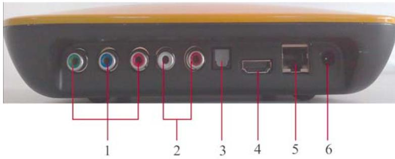
1. YPbPr分量输出 2.左右音频输出 3.数字音频光纤SPDIF输出 4.HDMI
