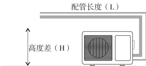
如果配管长度在7.5–15米之间，可按15g/m标准额外注入制冷剂。压缩机油不需要额外增加。
