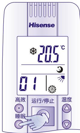
按下睡眠按钮，遥控器显示睡眠模式设定，在定时显示区域循环显示“01”、“02”、“03”、“04”、“无显示”5种状态。“01”~“04”4种睡眠状态时，“
