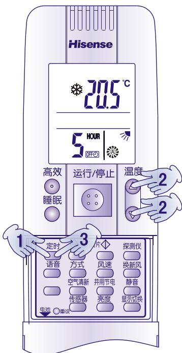
若空调器处于开机状态，经过定时器设定的时间后，空调器将停止运行。
