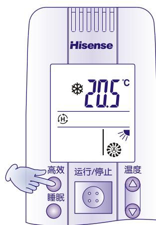
启用高效运行功能时，空调器以最大功率运行，输出更多的冷量或热量。可在冬天、夏天外出刚回家时使用，迅速使房间温度达到舒适状态。
