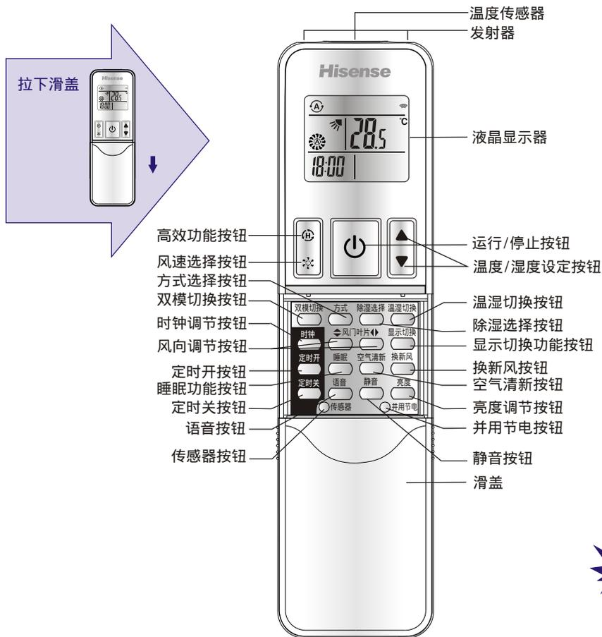
遥控器具有温度测试、显示功能。在一般状况下，空调器对室内温度的调节是以遥控器测得的温度为依据（具体内容参见下页）。
