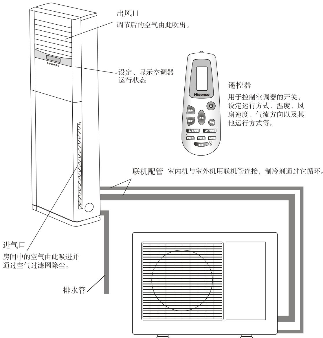
室外机 室外机包括压缩机、风扇、冷凝器、及其它电气元件。
