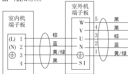
内外机联机线线径(YZW): $4 \times 1.5\text{mm}^2$
