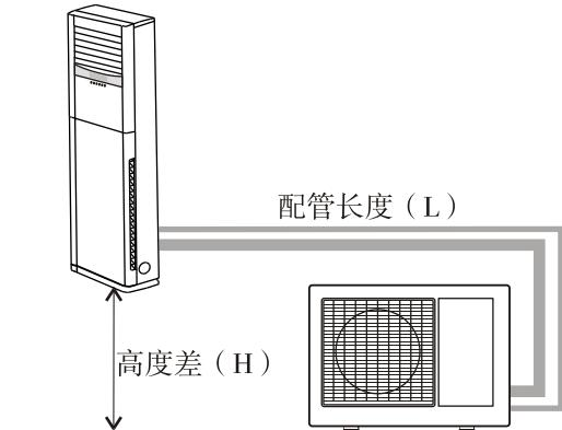
如果配管长度在7.5-15米之间，可按15g/m标准额外注入制冷剂（R22）。压缩机油不需要额外增加。
