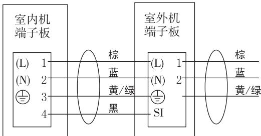
内外机联机线线径(YZW): $4 \times 1.5\text{mm}^2$
