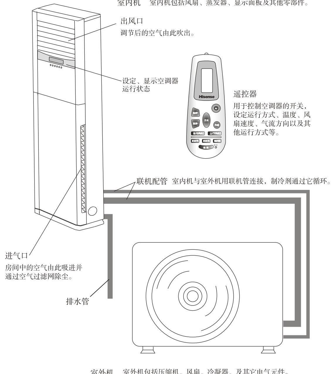
您的空调器由室内机、室外机及相关配件组成，您可使用遥控器或操作室内机显示面板控制空调器。
