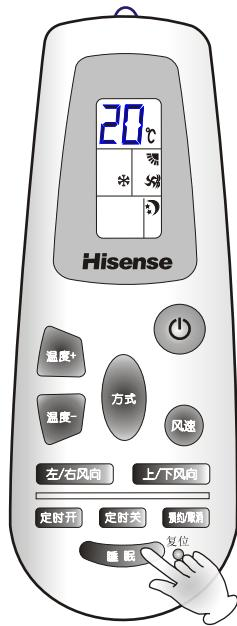
睡眠功能用于提高舒适性并节省电力，使房间温度在人体睡眠时达到最佳舒适状态。在运行状态下，按下睡眠按钮，遥控器上的“
