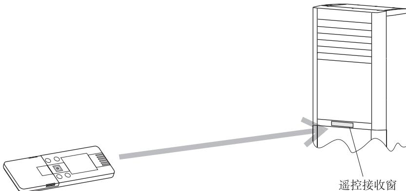
**遥控器的安装位置** 为确保本空调器正常运行，请勿将遥控器安装或放置在下列场合：
