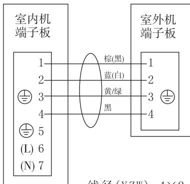
线径(YZW) :  $4 \times 2.5 \text{ mm}^2$
