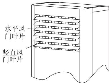
**A. 自动** 按动水平风门叶片按钮，将风门叶片状态设定为自动状态时，空调器的微电脑会自动的把水平风门叶片调节在适合的状态。
