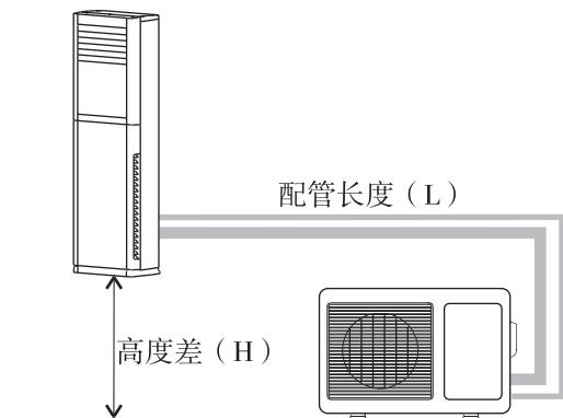
如果配管长度在7.5–15米之间，可按50g/m标准额外注入制冷剂（R22）。压缩机油不需要额外增加。
