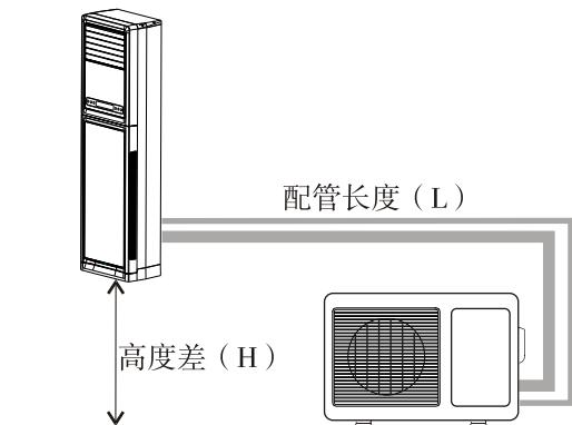
如果配管长度在7.5-15米之间，可按15g/m标准额外注入制冷剂。压缩机油不需要额外增加。
