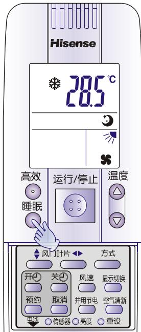
睡眠功能用于提高舒适性并节省电力，使房间温度在人体睡眠时达到最佳舒适状态。在运行状态下，按下睡眠按钮，遥控器上的“
