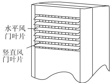
**A. 自动** 按动水平风门叶片按钮，将风门叶片状态设定为自动状态时，空调器的微电脑会自动的把水平风门叶片调节在适合的状态。
