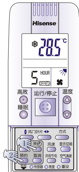
若空调器处于开机状态，经过定时器设定的时间后，空调器将停止运行。
