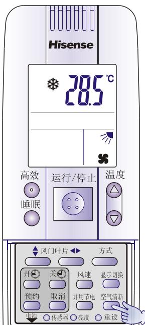
启动空气清新功能后，室内机的高效负离子发生器开始工作，能够有效地去除室内空气中的烟雾、灰尘和细菌，给您创造一个干净、清新的环境。
