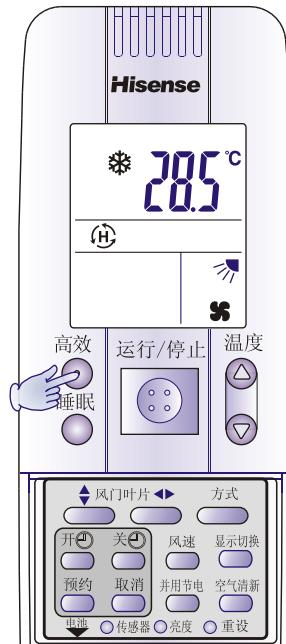
启用高效运行功能时，空调器以最大功率运行，输出更多的冷量或热量。可在冬天、夏天外出刚回家时使用，迅速使房间温度达到舒适状态。
