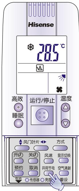
并用节电功能可以限制空调器最大运行电流，以便在用电高峰时能与其他电器同时使用。在空调器运行或停止时，可按下并用节电按钮启动并用节电功能，遥控器液晶屏上的“
