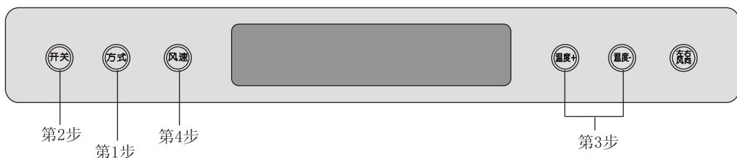
注：按键将在操作完成1分钟后自动锁定，显示屏上 标志闪烁；需要解锁请长按开/关按钮2秒，解锁成功会听到两声笛响，显示屏上 标志熄灭。
