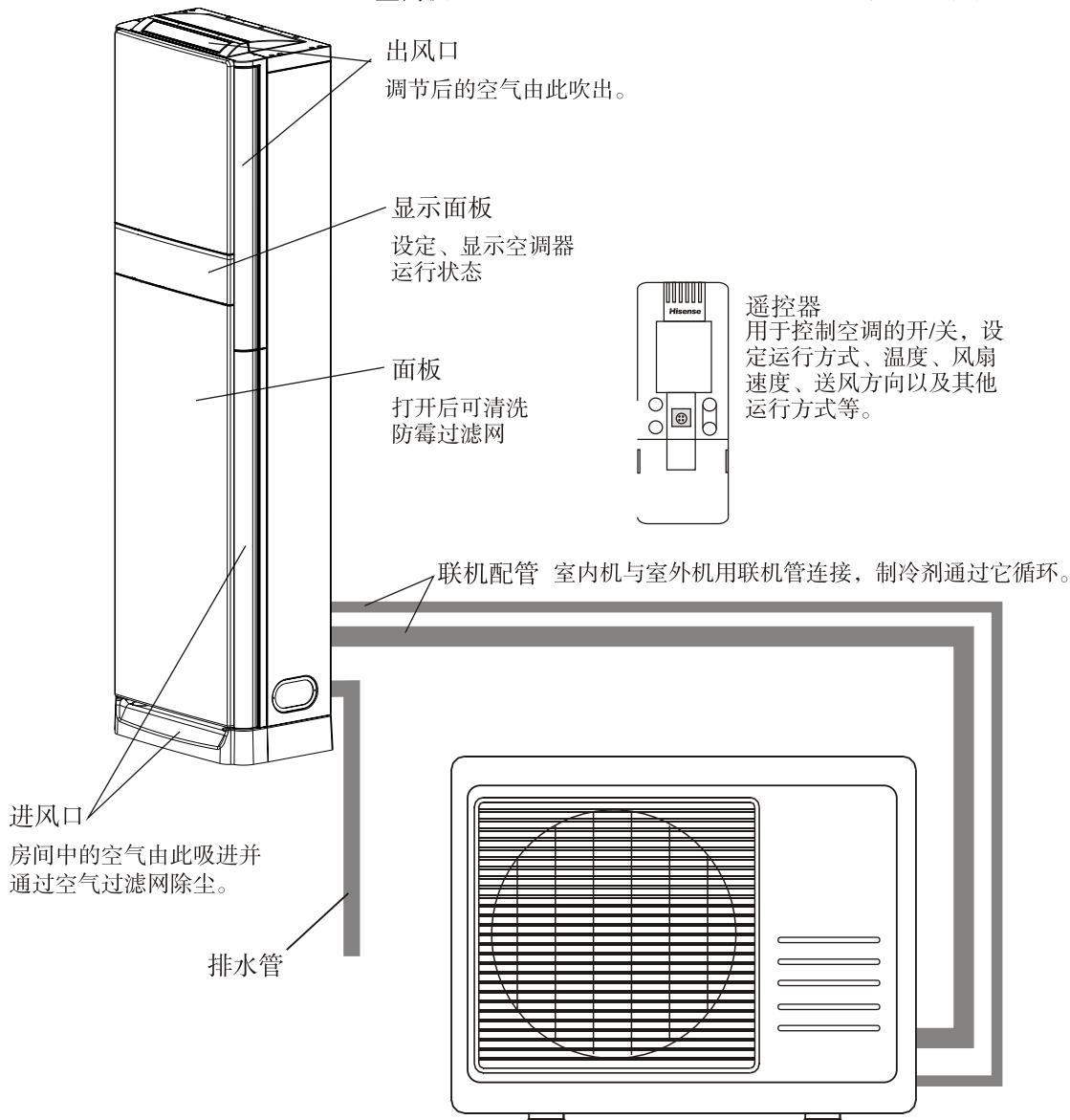
室外机 室外机包括压缩机、风扇、冷凝器、及其他电气元件。
