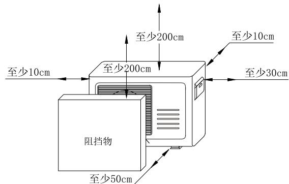
有结实的基座，离地面不低于12cm，避免室外机因潮湿或被腐蚀而损坏，减少寿命。
