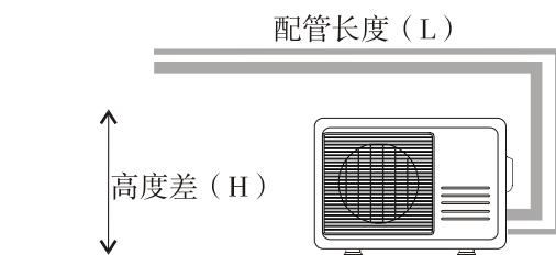
如果配管长度在7.5-15米之间，可按15g/m标准额外注入制冷剂（R410A）。压缩机油不需要额外增加。
