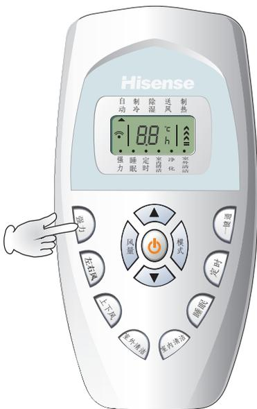
无论开关机状态，在遥控器上是“制冷”、“除湿”、“送风”时，按下此按钮，即按强力制冷模式运行。无按键操作则15分钟后退出该功能；在遥控器上是“制热”时，按下此按钮，即按强力制热模式运行。无按键操作则15分钟后退出该功能。
