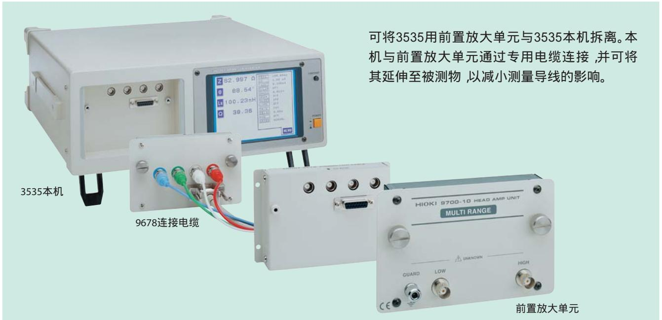
可将3535用前置放大单元与3535本机拆离。本机与前置放大单元通过专用电缆连接,并可将其延伸至被测物,以减小测量导线的影响。
