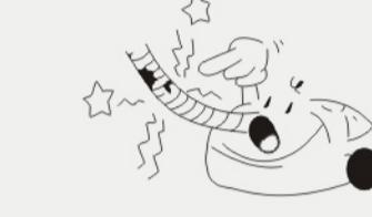
**请不要用吸尘器吸水泥、石膏粉、墙粉等微小颗粒，否则会引起吸尘器过滤部件堵塞，电机烧坏等故障，如果吸入上述微小颗粒，请及时清理过滤部件。**
