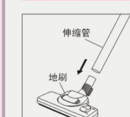
连接时，将地刷管插入伸缩管口径较大的一端内，然后相反用力加以转动以连接牢固。
