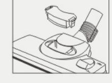
若有异物卡在软管中，可拔下软管，并将弯管的前端置于吸尘器进风口内，让管内空气反向流通，以吸出异物。
