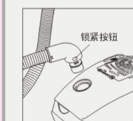
1. 将软管接头捏住，对准吸尘器进风口插入，直至其锁住为止。
