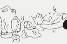
**使用吸尘器时，请不要吸入头发、大纸团等易使吸入口或吸管、软管堵塞的物品，否则可能引起电机故障或外壳变形。如果吸入造成堵塞，请及时停止电源线并拔出插头清理。**
