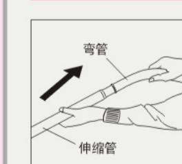
连接时，将伸缩管口径较小的一端接到弯管上，然后相反用力加以转动以连接牢固。
