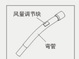
除了用调速按钮控制吸力大小外，还可以由弯管上通过前后滑动风量调节块来调节吸力，方孔的面积露的越多，吸力越小。
