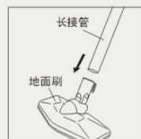
连接时，将长接管管径较细的一端插入地面刷管内，然后相反用力加以转动以连接牢固。
