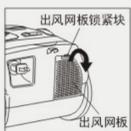
按下出风网板锁紧块，向外拉出出风网板，取出出风过滤片，即可更换或清洗出风过滤片。
