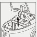
打开前盖，从进风过滤片框中取出进风过滤片，即可更换或清洗进风过滤片。
