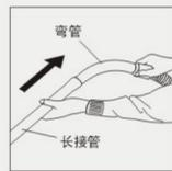
连接时，将长接管管径较大的一端接到弯管上，然后相反用力加以转动以连接牢固。
