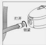
1. 将软管接头捏住，对准吸尘器进风口插入，顺时针转动直至其锁住为止。
