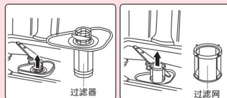
如图所示，拆下过滤器及过滤网在清水中清洗。
