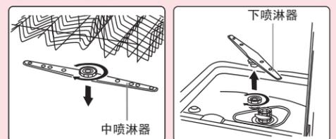
如图所示，拆下喷淋器在清水中清洗。
