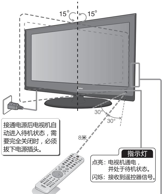
遥控器有效操作距离最远为8米。有效操作角度为垂直于信号接收窗口左右30°。
