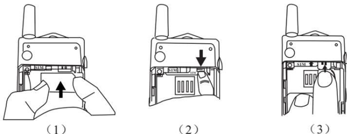
**注意：**取出SIM卡后，请检查SIM卡推拉片是否已被推入槽中，然后再安装电池，以免电池将推拉片压变形，如图（3）所示。
