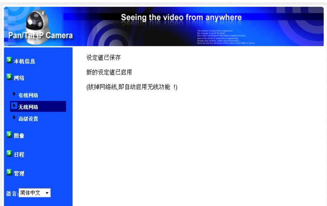
图 31: 无线设置成功，断掉网线，无线启用
