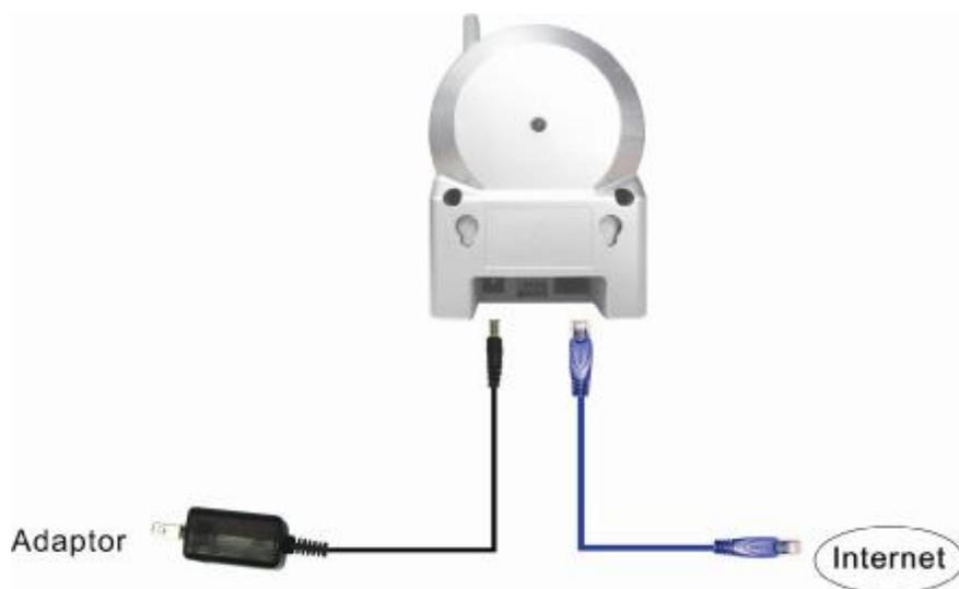
图 3：网络摄像机连接图。
