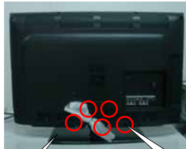
7. 整机拆卸之-----底座的拆卸
