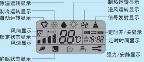
注：未做介绍按键或显示，本书机型无此功能。辅热键按下后显示辅热符号，实际机型没有辅热功能。
