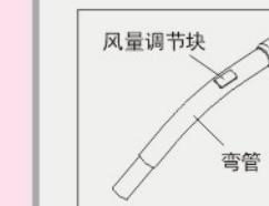
除了用调速按钮控制吸力大小外，还可以由弯管上通过前后滑动风量调节块来调节吸力，方孔的面积露的越多，吸力越小。
