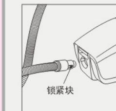
1. 将软管接头对准吸尘器进风口插入，注意锁紧块要与进风口槽口对齐，然后顺时针旋紧。
