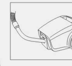
若有异物卡在软管中，可拔下软管，并将弯管的前端置于吸尘器的进风口内，让管内的空气反向流通，以吸出异物。
