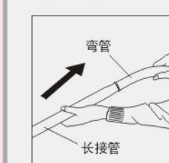
连接时，将长接管口径较小的一端接到弯管上，然后相反用力加以转动以连接牢固。
