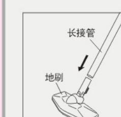
连接时，将地刷管插入长接管口径较大的一端内，然后相反用力加以转动以连接牢固。
