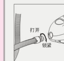
1. 将软管接头捏住，对准吸尘器进风口插入，顺时针转动直至其锁住为止。
