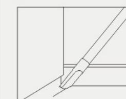
在角落及有缝隙的场合可使用扁吸嘴。
