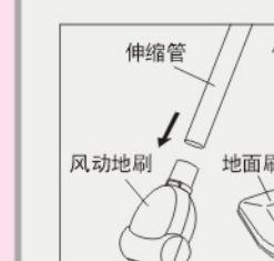
连接时，将伸缩管管径较细的一端插入地刷管内，然后相反用力加以转动以连接牢固。
