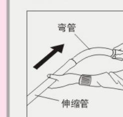
连接时，将伸缩管管径较大的一端接到弯管上，然后相反用力加以转动以连接牢固。
