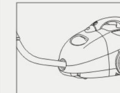
若有异物卡在软管中，可拔下软管，并将弯管的前端置于吸尘器的进风口内，让管内的空气反向流通，以吸出异物。
