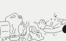
使用吸尘器时，请不要吸入头发、大纸团等易使吸入口或吸管、软管堵塞的物品，否则可能引起电机故障或外壳变形。如果吸入造成堵塞，请及时停机拔下插头清理。
