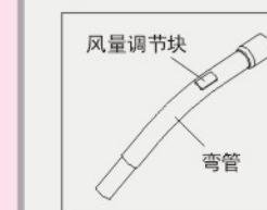
除了用调速旋钮控制吸力大小外，还可以由弯管上通过前后滑动风量调节块来调节吸力，方孔的面积露的越多，吸力越小。
