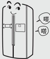
液体制冷剂在蒸发器内流动时，会发出类似“流水”的声音。这种声音一般发生在蒸发器和压缩机两部分；当冰箱停止工作时，液态工质回流，也会连续或间断地发出像流水一样“哗哗”的声音。
