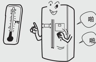
压缩机工作时发出的声音，以及开、停机时压缩机发出的嗒嗒声，这是正常现象。
