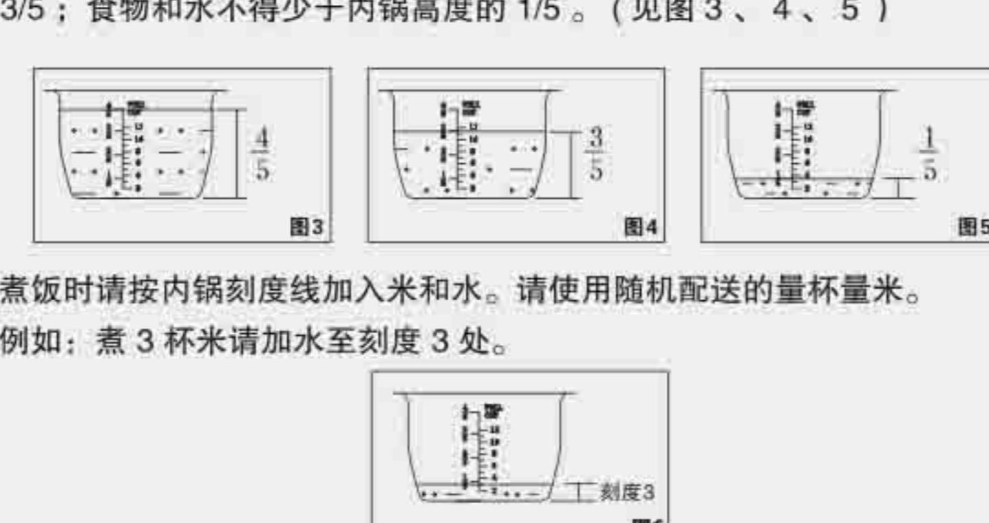
□ 煮饭时请按内锅刻度线加入米和水。请使用随机配送的量杯量米。
