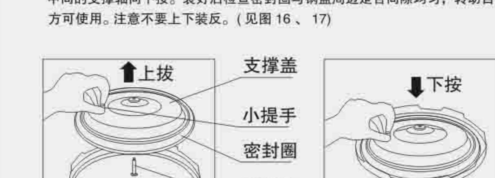
2) 防堵罩的清洗。把防堵罩向上拉出，清洗干净后，向下按至安装好。（见图 18、19）
