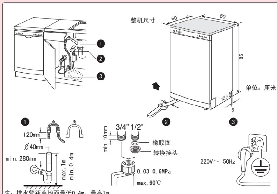
注:排水管距离地面最低0.4m,最高1m。
