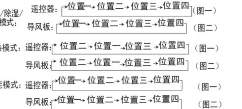
注：空调在使用遥控器或控制盘关机时，会将上下导风板关闭，在直接切断电源时，导风板将无法关闭；请使用遥控器或控制盘关机，切勿在关机前直接切断电源。
