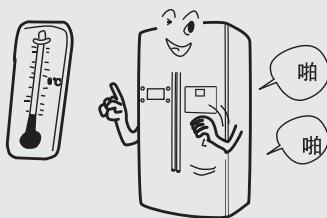
压缩机工作时发出的声音，以及开、停机时压缩机发出的嗒嗒声，这是正常现象。
