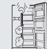
门没关严或频繁开启冰箱门、开门时间过长
