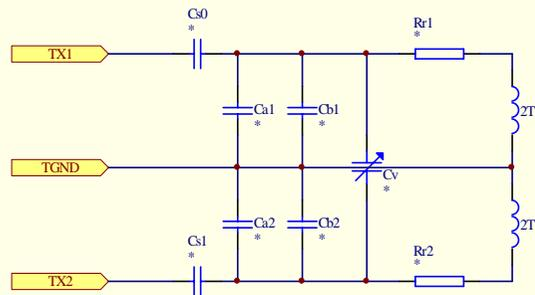
天线线圈，一般情况下直接在PCB板上绘制线圈中心抽头，线圈大小根据PCB板的实际情况和需求（如读卡距离）而定，不要太小，也不能太大，若线圈面积过小，可以考虑在线圈中心加铁氧体磁芯，线圈的圈数也需要根据实际的电感量而定，一般为4T，中心抽头，线圈的电感量一般在1uH左右（可以通过线圈圈数和面积调整）。
