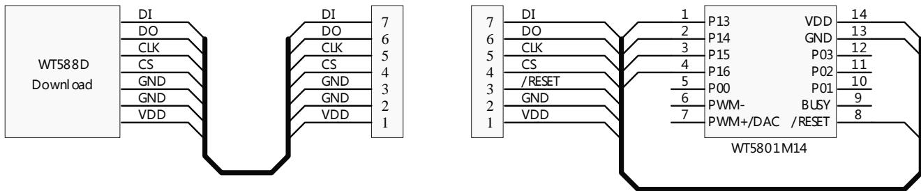
在线下载需要配合 WT588D Download 下载器使用，从 WT588D Download 下载器上引出如图中所示的 7 根下载线到 WT5801M14 即可下载。
