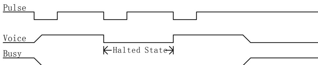
备注：负脉冲触发。第一个脉冲令正在播放的语音处于暂停状态，第二个脉冲触发暂停的语音在暂停点继续播放。BUSY在暂停状态一直保持。
