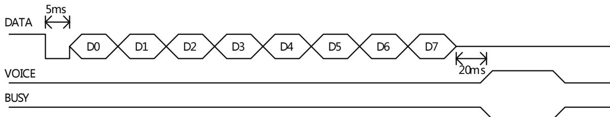
说明：一线串口模式下 WT5801M14无法进入休眠状态，语音停止状态电流为5mA，请在电池供电时慎用。DATA 为一线串口数据通信线，WT5801M14语音模块每次通电后要等17ms 才能开始发送数据信号，BUSY 为 WT5801M14语音模块忙信号输出，数据成功发送后等待20ms，BUSY 输出将作出响应。数据位占空比对应详见下图。
