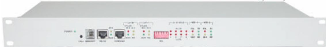
图 5.11 GSD202F04V2-D 光端机前面板示意图
