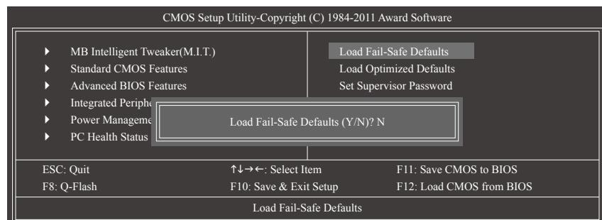
在此选项按<Enter>然后再按<Y>键，即可载入BIOS最安全预设值。如果系统出现不稳定的情况，可尝试载入最安全预设值。此设定值为最安全、最稳定的BIOS设定值。
