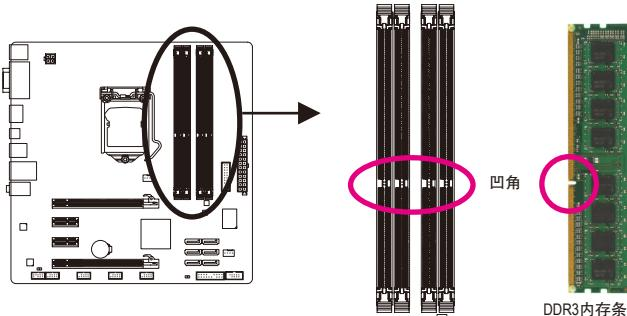
DDR3内存条上有一个凹角，只能以一个方向安装至内存条插槽内。请依下列步骤将内存条正确地安装于主板的内存插槽内。
