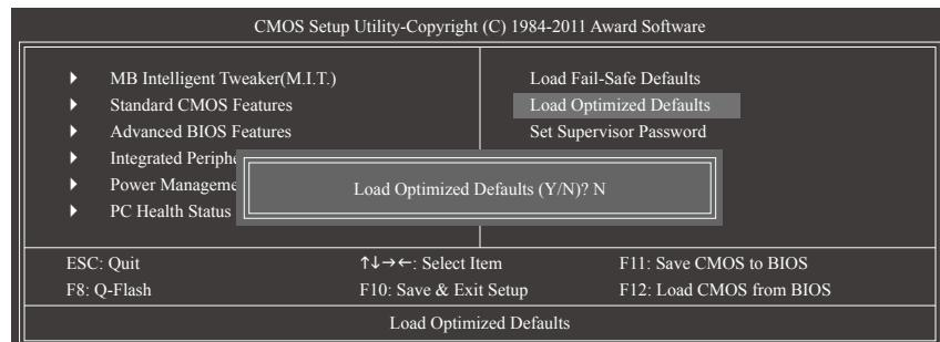
在此选项按<Enter>然后再按<Y>键，即可载入BIOS出厂预设值。执行此功能可载入BIOS的最佳化预设值。此设定值较能发挥主板的运行性能。在更新BIOS或清除CMOS文件后，请务必执行此功能。
