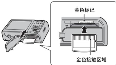
将金色标记与金色接触区域对准，然后将 **xD-Picture Card** 卡完全插入。
