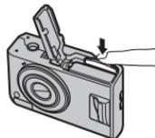
将 **xD-Picture Card** 卡按入插槽，然后慢慢放开手指。锁定装置松开，然后 **xD-Picture Card** 卡弹出。
