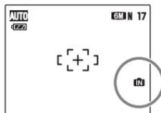
在没有 **xD-Picture Card** 卡时，**FinePix F31fd** 有可保存图像的内存。当运行内存时，**iN** 显示在 LCD 显示屏上。
