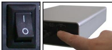
注意！手動關閉 **Freecom Blu-ray Rewriter Pro / Blu-ray Combo Pro** 之前，請先確定已先將其安全地從作業系統移除（**Windows** 工作列上的「拔下或退出硬體」選項）。未執行此程序可能導致資料遺失。
