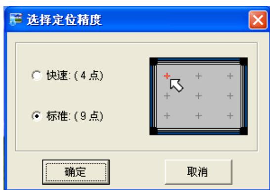
2) 选择定位精度后，点击[确定]按钮，便会出现定位界面，根据定位界面上的箭头指示，用电子笔或无色书写笔（或手指）点压板面闪烁的红色十字定位框的绿色中心点，如果点压的该点变成绿色，则该点定位成功，下一个定位点变红，箭头同时移至该定位点，整个定位过程是通过电子笔或无色书写笔（或手指）按箭头提示来顺序点击板面上 9 个（4 个或 9 个）闪烁交叉点的简单过程。
