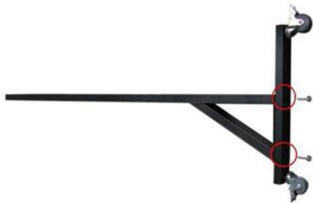
(3) 分别用两套外六角螺丝（套件 1）固定在每根立柱上，注意在六角螺丝的末端留 4mm 左右的间隙用于挂接白板。
