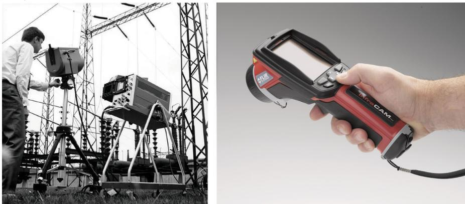
圖 15.1 左圖：Thermovision® 661 型誕生於 1969 年。這款熱像儀重量大約在 25 公斤左右，示波器重 20 公斤，三腳架重 15 公斤。操作者也需要 220 VAC 的發電機裝置，和 10 升裝了液態氮的罈子。可以在示波器左邊看到拍立得 (Polaroid) 附件 (6 公斤)。右圖：InfraCAM 誕生於 2005 年。重量爲：0.55 公斤，包括電池。
