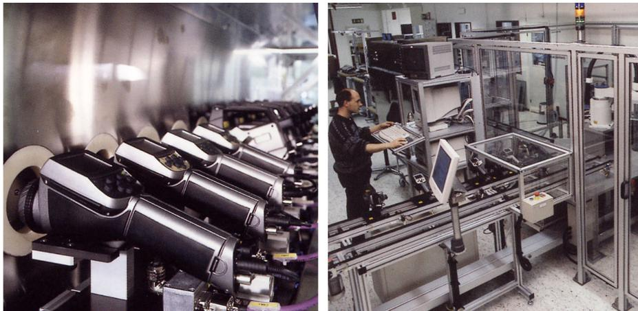
圖 15.4 左圖：在環境室中測試紅外線熱像儀；右圖：熱像儀測試和校準機器人。
