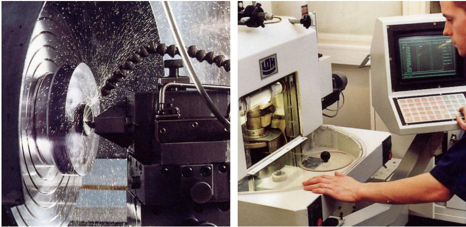
圖 15.3 左圖：金剛石車削機床；右圖：鏡頭拋光。
