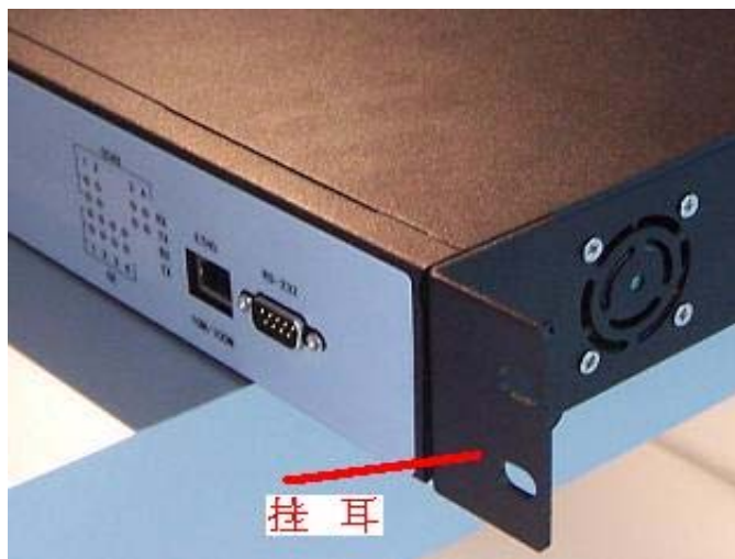
图 5-1 将挂耳固定在 FS4100 系列 OC48 过滤设备的机箱上
