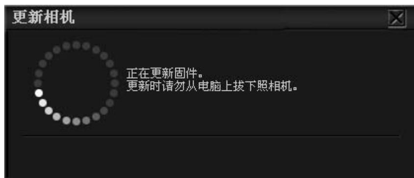
7. 相机机身在固件升级的执行中，更新完成后液晶显示屏上出现“OK”，请单击[下一个]。
