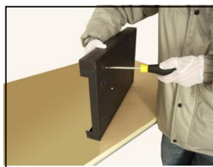
④安装固定硬盘螺丝
