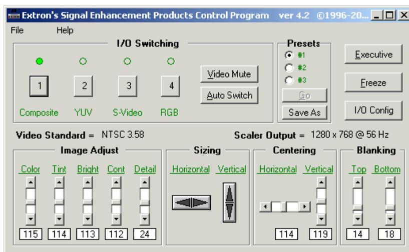
3. I/O Config ボタンをクリックして、I/O Configuration ダイアログボックスで入力を設定します。
