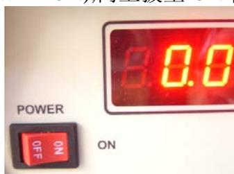
2、选择量程：根据被测物体带电电量的多少选择合适的量程。若事先不能估计被测物体带电电量的多少,应把量程开关拨至最大量程(20 $\mu$ C)，以免过电压烧坏仪器内部静电计放大器。若读数很小或读数为零，可逐渐换用较小的量程。
