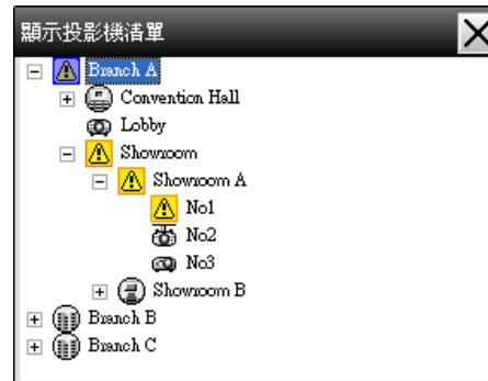
在投影機清單中，無論環境設置的顯示群組檢視的溫度等級設定為何，皆不會顯示溫度等級圖示。
