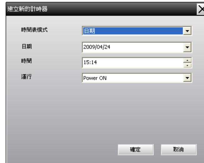
在運行中，您可進行開閉電源及切換輸入源的操作，就像在主視窗使用控制按鈕進行操作一樣。如果已設定輸入源切換，即使投影機的電源此刻沒有打開，其電源也會在定時器啟動的時間開啟。因此，無須對電源開啟和輸入源切換分別進行設定。
