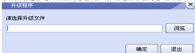
在【升级程序】对话框中点击【浏览】按钮，选择升级文件，点击【确定】按钮，开始升级。升级成功后会在【状态】提示中显示“升级成功”。解码器会自动重新启动。升级完毕点击退出。
