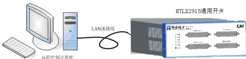
图 8 LXI2915 多路开关模块调试系统连接图
