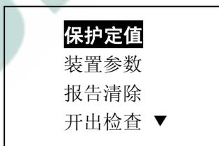
选中“保护定值”条目，按“Enter”键，输入保护定值区号，按“Enter”键进入保护定值整定界面。按“▲”“▼”“◀”“▶”键可以将光标移动到所需要整定的位置，按住“▲”“▼”键不放，菜单会一直向上或下向滚动，找到需要整定的定值时放手，通过“+”“-”键改变数字大小，当全部定值整定完毕按“Enter”键可将定值固化。在整定定值的过程中，保护被闭锁。如果在保护定值整定界面按“Enter”键，则返回到装置整定菜单。
