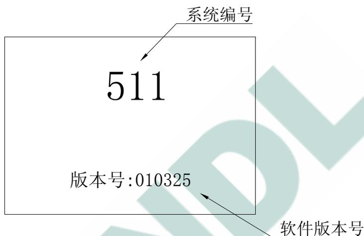
装置正常工作时，显示系统编号、软件版本号。
