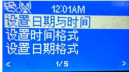
E.操作完上面的步骤就会进入下面的界面（通过"Next"键和摇控器上面的数字键,输入您需要的日期和时间,再按"OK"键返回到上一个菜单）
