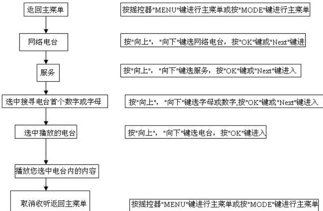
**b.添加新电台的操作流程图**
