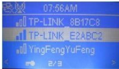
f.输入路由器设置联网的密码(通过"Next"键和遥控器上面的数字键,输入密码,再按"OK"键返回到网络设置菜单)
