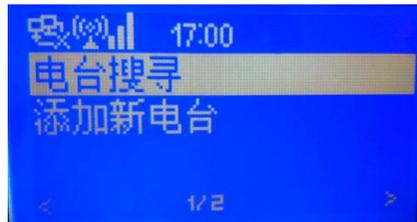
3.3.1.5 选择电台搜寻相应的字母以数字 **0-9** 为例说明 (通过"向上"或"向下"键选中电台搜寻相应的字母,再按"OK"键或"Next"键,进入下一个操作)
