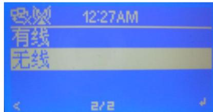
注:DHCP(关), IP 地址,子网掩码,默认网关,主 DNS,次 DNS,都与 2.2.4.1.1.1 c 到 g 点有线 IP 属性一样,设置完后,按"OK"键返回到下面的子菜单。
