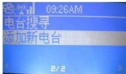
3.3.2.3:进入到下面界面,输入添加电台的网址(通过摇控器上面数字按键,再按"OK"键或"Next"键,进入)
