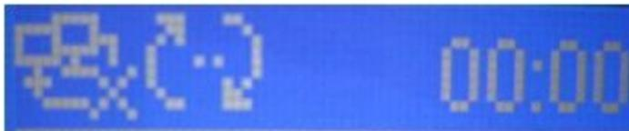
h.等待几十秒钟左右后。左上角第二个图标会变为下图状态,表示网络联接 OK,设置完成.
