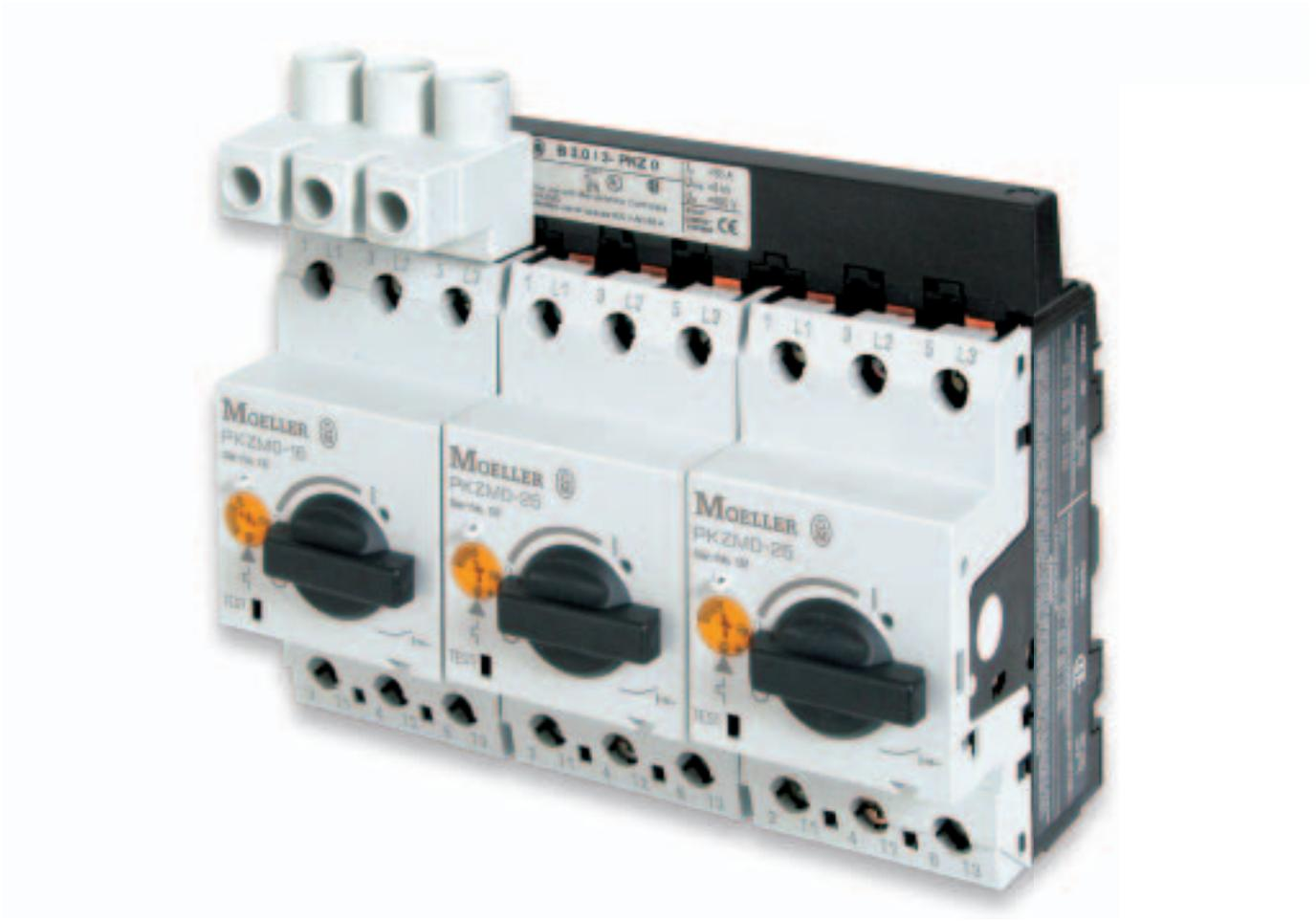
**Bild 8:** Eine Gruppe Motorschutzschalter PKZM0 ist einspeiseseitig mit einem Drehstromschienenblock verbunden. Die Schutzschalter besitzen einen gemeinsamen Einspeiseklemmblock BK25/3-PKZO-E. Er erfüllt mit den vergrößerten Luft- und Kriechstrecken die Anforderungen an den "Construction Type E".
