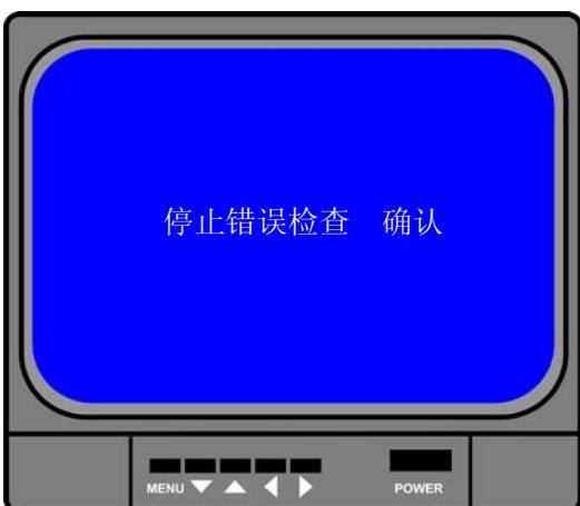
突发的电源故障有可能会导致硬盘数据丢失，在检测到数据丢失后，系统会自动检查错误并恢复至主画面。
