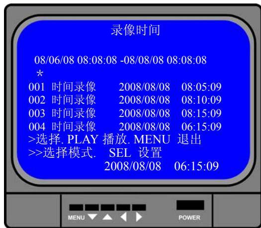
系统提供直接查询时间点录影的方法：用户首先进入“录像时间”菜单，先按“▶▶FWD”键，然后“▲UP”或“▼DOWN”移动光标，再按“◀ SEL”键输入时间，确定后按“▶PLAY”即可播放。
