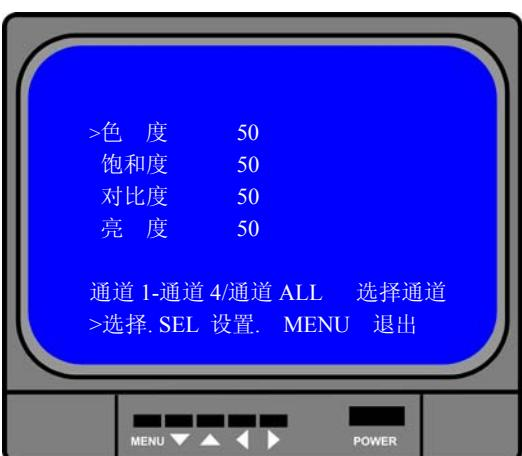
用户可按“CH1”，“CH2”，“CH3”，“CH4”选择要调整的画面，再按[▲UP]键和[▼DOWN]键来移动光标，接着按[←SEL]键来进行修改，修改完毕后再按**[MENU]**键完成设置并返回。
