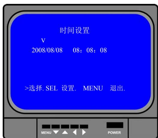
在“时间设置”菜单里，用户设置时间可通过[▲UP]键和[▼DOWN]键来移动光标，再按[←SEL]键来进修改，修改**[MENU]**完毕后再按键完成设置并返回。
