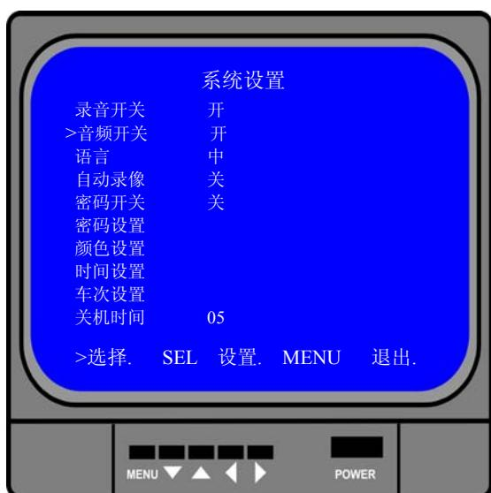
在系统菜单中,将光标移到 "音频开关", 用户可按[ $\leftarrow$ SEL]键来设置录音 "开" 或 "关", 当用户设置 "开" 时, 才有音频输出.
