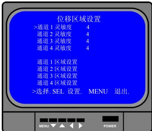
要启用移动侦测录像，先在“录像设置”菜单中将录像触发方式设置为“M”（移动侦测触发录像模式），请参照本说明书 5.7 章节。
