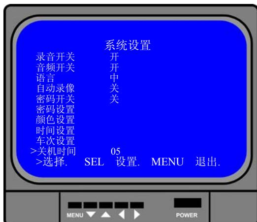
用户可通过[▲UP]键和[▼DOWN]键来移动光标到“关机时间”，再按[←SEL]键来进修改，修改[■MENU]完毕后再按键完成设置并返回
