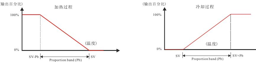
P 值越大，超温的情形会越小，上升的时间较慢，适用于反应较快的系统。P 值越小，超温的情形会较大，上升的时间较快也较容易产生控制震荡的情形，适用于反应较慢的系统。
