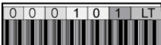
Figure 1-1. Exemple d'étiquette de codes barres LTO pour média WORM
