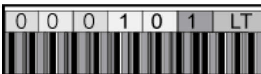
Abbildung 1-1. Beispiel für LTO-Strichcode-Etikett für WORM-Medium
