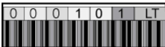
Figura 1-1. Ejemplo de etiqueta de código de barras LTO para soporte WORM
