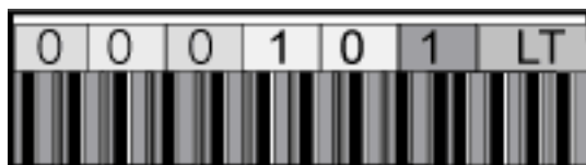
图 1-1. WORM 介质的 LTO 条形码标签示例
