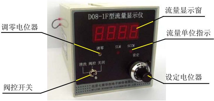
图 2. 1F 型流量显示仪外观
