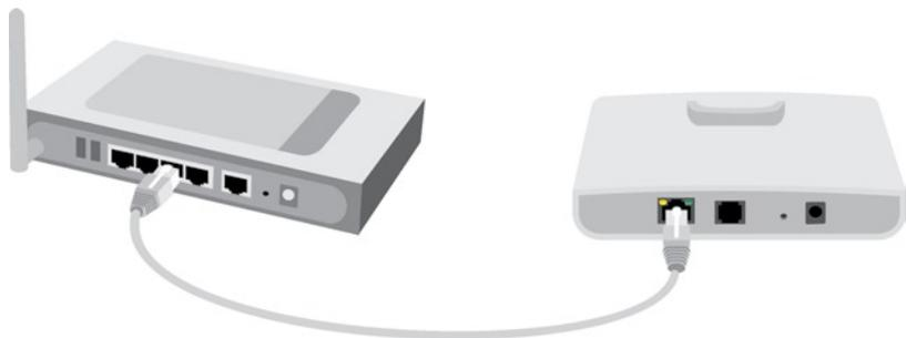
將網路線一端連接到位在DHA-130底座後方的網路埠(LAN)，另一端接在路由器。
