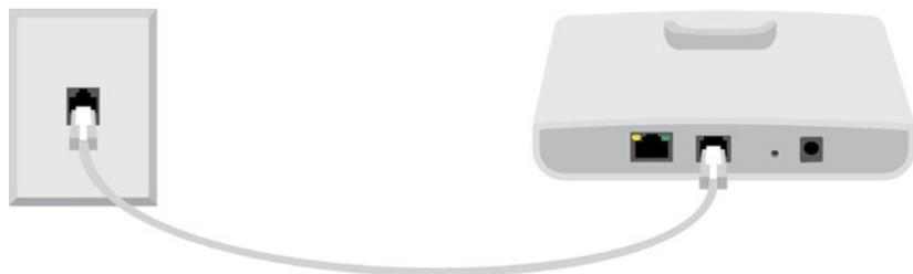
將電話線一端連接到位在DHA-130底座後方的一般市話埠(LINE)，另一端接在牆上電話線插孔 (PSTN)。
